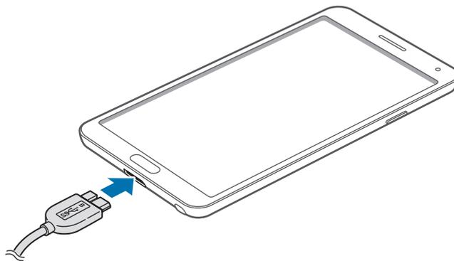
Lorsque vous utilisez un câble USB 2.0, branchez ce câble sur le connecteur à fonctions multiples situé à droite de l'appareil, tel qu'illustré ci-dessous.
