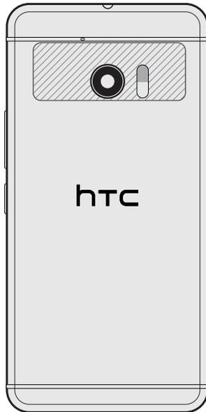
Assurez-vous que la zone NFC (partie hachurée) du HTC 10 et la zone NFC de l'autre téléphone sont proches l'une de l'autre. Faites des essais en déplaçant légèrement les téléphones jusqu'à ce qu'une connexion soit établie.
