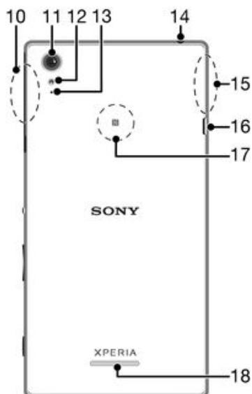
10 Surface de l'antenne Wi-Fi / Bluetooth
